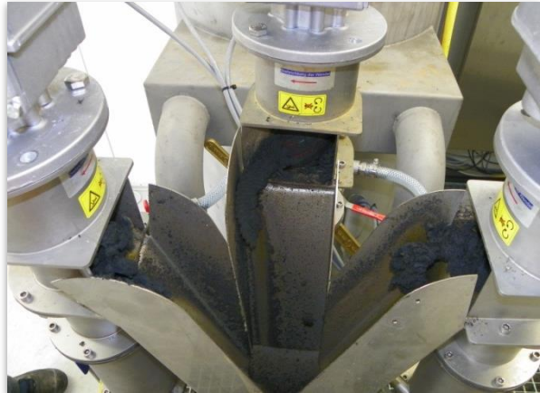
Klärschlamm entwässerung in Container-Bauweise, Innenansicht
